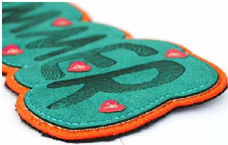
Un diseño con rellenos de láser. El texto en el diseño es grabado utilizando rayos láser.
